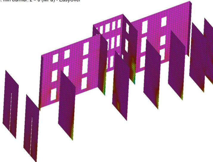
L'indicatore di rischio sismico è dato dal rapporto fra capacità e domanda in termini di PGA.
