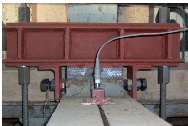
Figura 7. Traversa per la trasmissione del carico collocata sul blocco in fusione al piede del lucernario ed accelerometro n°1 posizionato sull'estradosso del corrente superiore.
