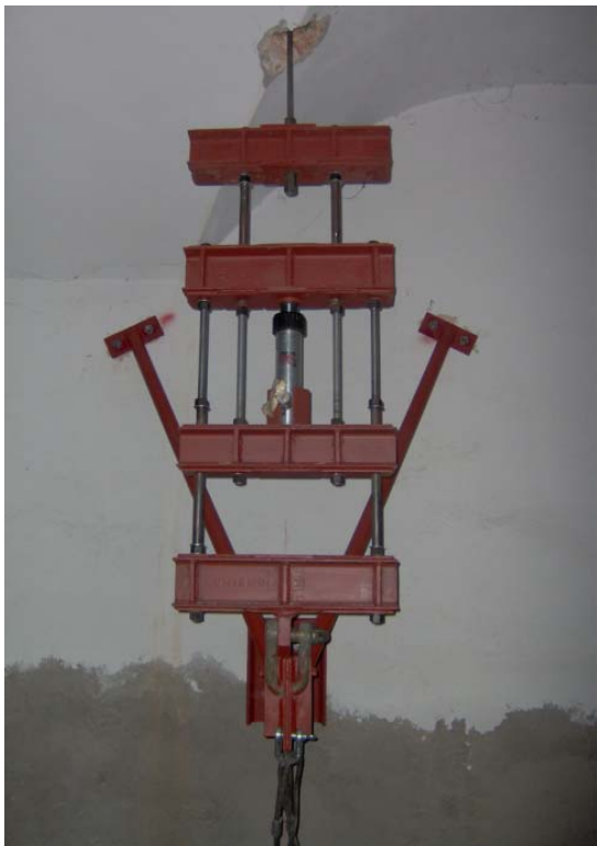
Figura 2. Foto del dispositivo di contrasto ed invertitore del carico.
